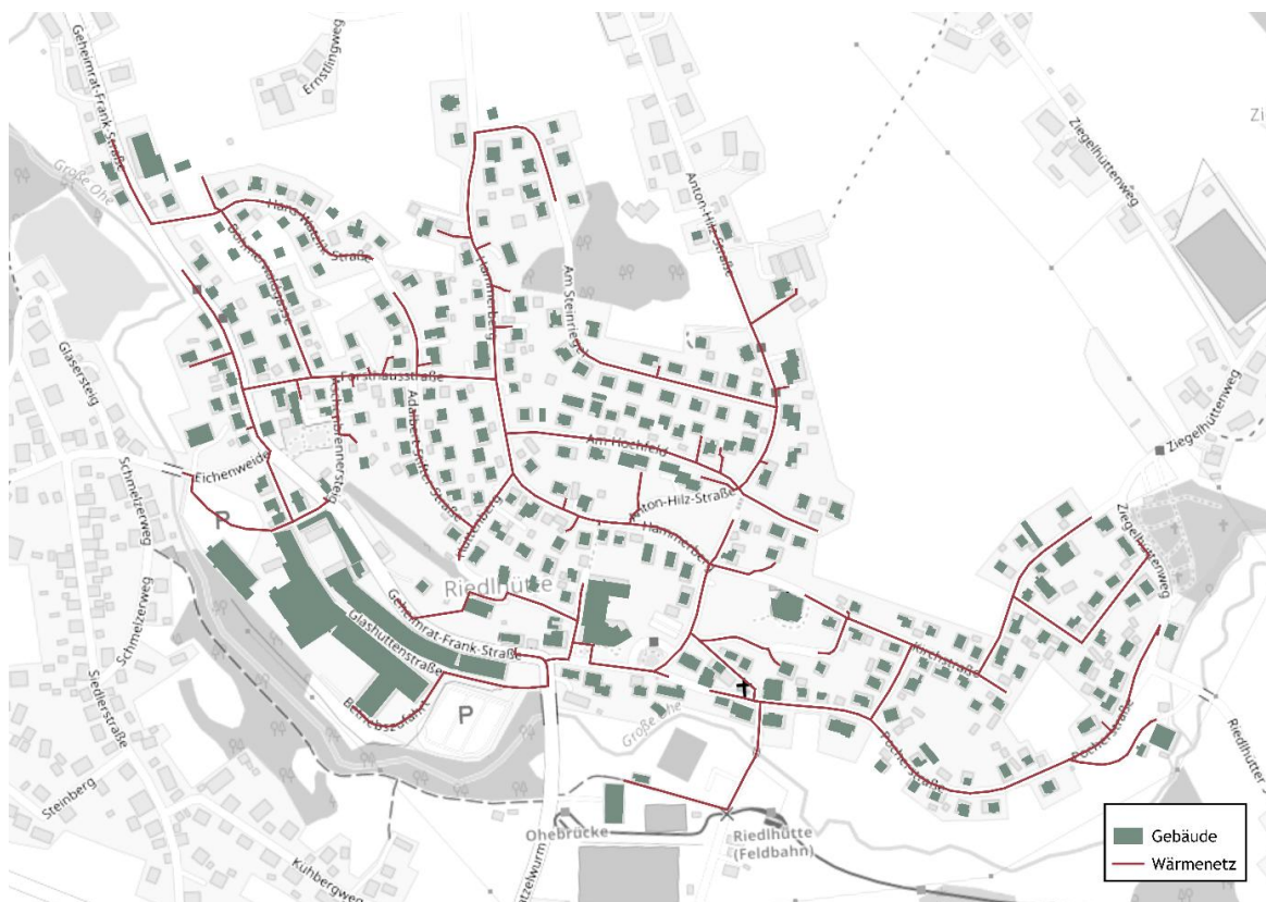
Abbildung 19: Untersuchtes Wärmenetz, eigene Darstellung
